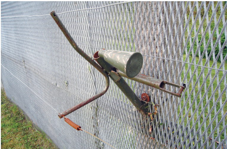
1선 철조망에 동독 국경수비대가 가설해 놓은 부비 트랩 형태의 소련제 SM-70 대인 지뢰. 철조망을 건드리면 콘 형태의 강통 속에 들어있는 수많은 파편 조각들이 사방으로 폭발하면서 비산되어 탈주자를 죽이거나 치명상을 입게 만든다. 지뢰와 연결된 2개 전선 중 어느 것 하나 하고만 닿아도 즉시 폭발된다. (사진출처: http://commons.wikimedia.org/ )
